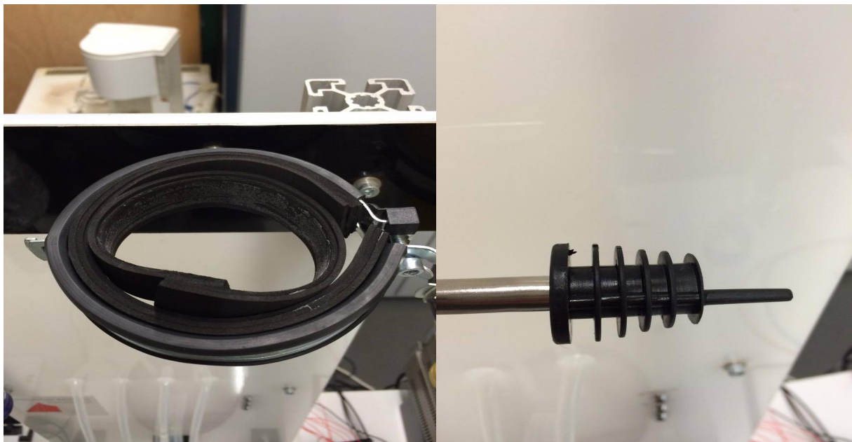
Abbildung 8: Rohrschelle als Flaschenhalterung Abbildung 9: Ausgussadapter
